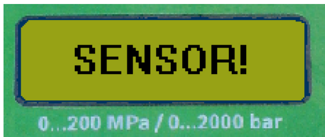
Abb. 12: Mensagem de erro no medidor digital de pressão
