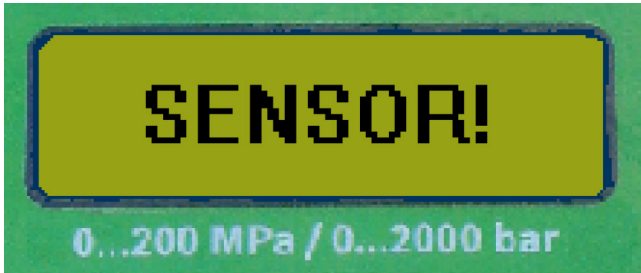
Abb. 12: Digitaalisen paineennäyttölaitteen vikailmoitus
