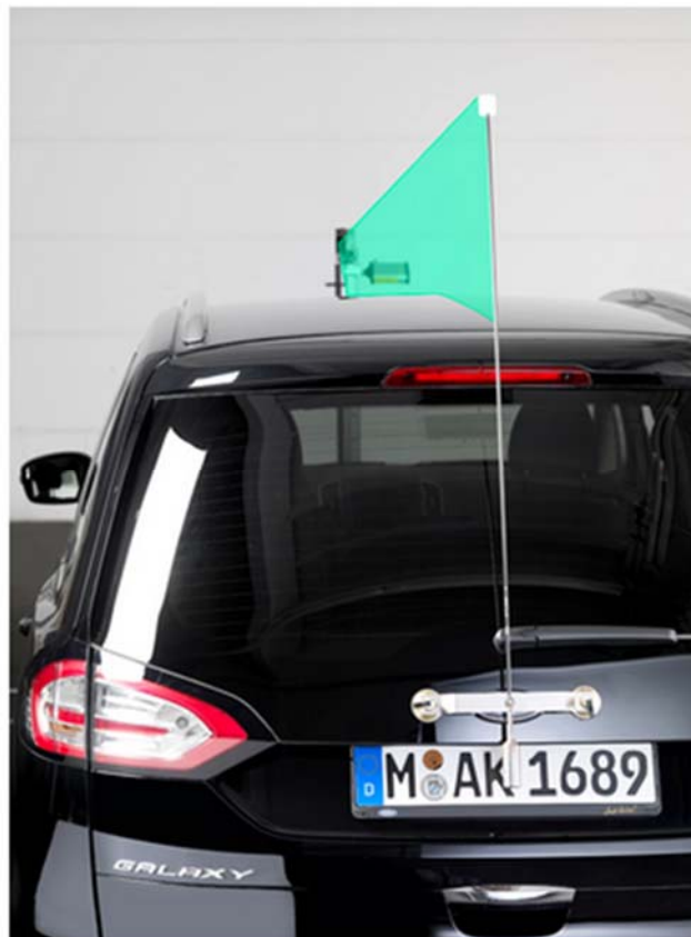
Scheinwerfer-Einstell-Prüfgerät HTD 8xx Säule außermittig auf dem Fahrgestell vertikaler grüner Linienlaser im Zusammenspiel mit am Fahrzeugheck angebrachtem Peilstab (Pendeltarget)
