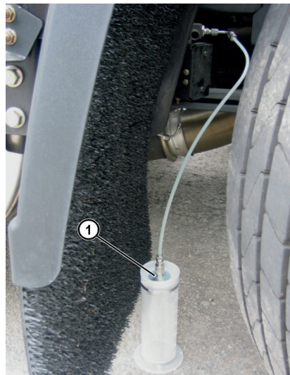
Fig. 8: Contrôle du débit de la pompe_2
