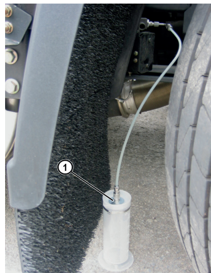
Fig. 8: Testning av pumpens matningsmängd_2
